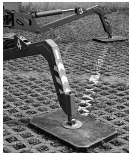
Fig. 6: se il terreno è cedevole, le piattaforme di lavoro dotate di stabilizzatori devono poggiare su una piastra di appoggio.
