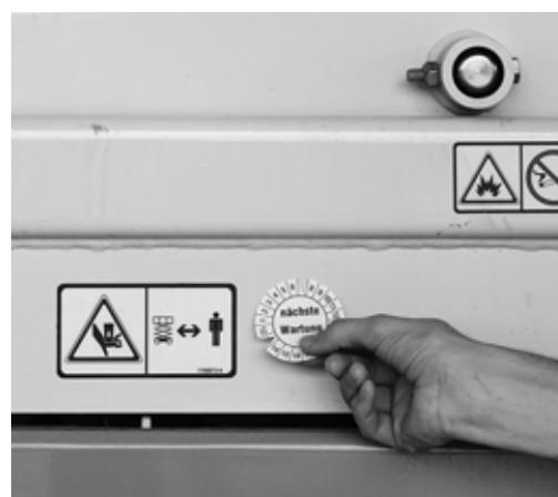
Fig. 4: la data del successivo intervento di manutenzione può essere indicata con un'etichetta adesiva apposta direttamente sul mezzo.
