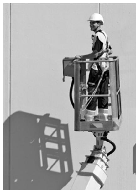
Fig. 9: sulle piattaforme a braccio articolato o telescopico il personale deve usare le imbracature anticaduta. Attenzione! Utilizzare solo i punti di aggancio consentiti e previsti e regolare la fune di trattenuta in modo in modo che sia più corta possibile.
